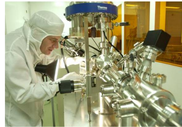
*Microfabrication de composants piezo-électriques de type SAW (Surface Acoustic Waves).*
