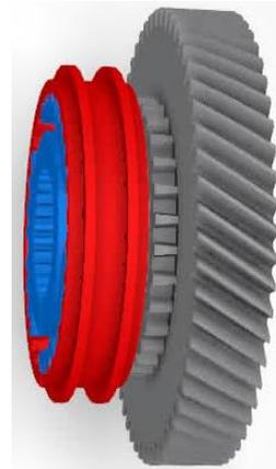
Analyse, Modélisation et simulation du comportement dynamique d'un baladeur de boite de vitesses
