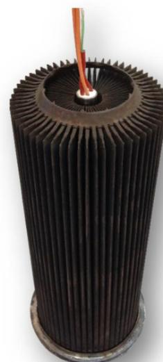
Figure 25 : système de régénération par cartouche électrique placée au cœur du filtre
