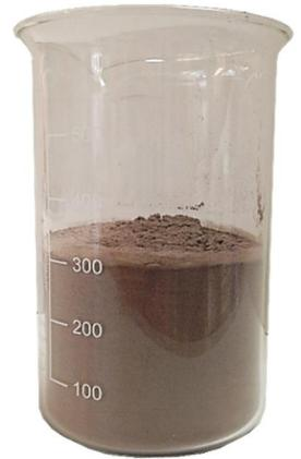
Figure 36 : ex. 120 g de cendres récoltées par un cyclone Storch pour une charge de bois de 41 kg
