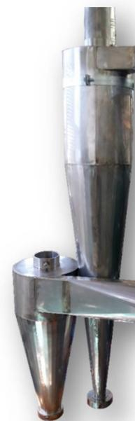
Figure 31 : cyclones développés selon les modèles de Lorenz (gauche) et de Storch (droite)
