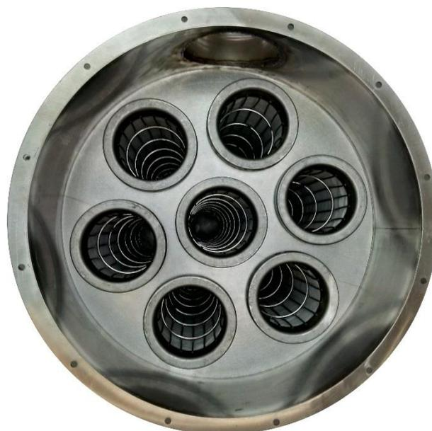
Figure 51 : positionnement des manches dans le caisson de filtration
