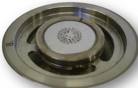
Figure 18 : exemple de particules collectées par classe via l'impacteur en cascade Elpi+
