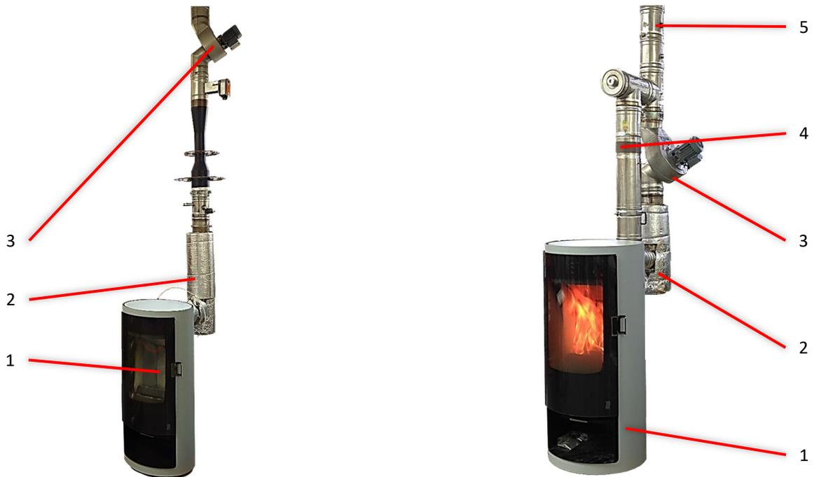
Figure 23 : configuration de montage du banc classique vs. avec bypass
