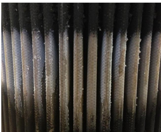
Figure 24 : ex. de régénération partielle (en gris) de la surface d'un FAP par rayonnement
