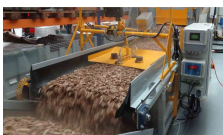
Installation de mesure utilisée pour l'essai de terrain chez le fournisseur de plaquettes de bois Germaplaket à Yverdon. Photo: B. Vogel
