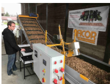
Thierry Stäger, chercheur à la HEIG-VD se sert de la nouvelle installation de mesure. Le boîtier gris argenté au-dessus du convoyeur est l'instrument infrarouge pour la mesure de l'humidité. Photo: B. Vogel
